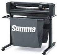
La SUMMA D60R est un plotter de découpe hérité du rouleau de traction breveté des SummaSign Pro qui vous garantit une traction au dixième de millième près, sur des coupes jusqu'à 8 mètres de long. l'alignement est parfait grâce aux flasques latéraux et possède un système OPOS X pour la réalisation des détourages d'images ou la réalisation de stickers.
