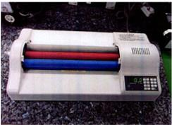
La Proteus A3 est une plastifieuse à pochettes professionnelle A3 qui peut plastifier à froid pour plastifier jusqu'à 180 documents A4 en 1 heure jusqu'à 250 microns par face avec une vitesse de plastification maximum de 95 cm/min. L'utilisateur aura à la possibilité d'ajuster indépendamment la température et vitesse de plastification.
